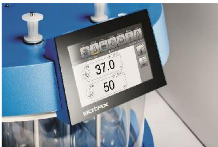
*Operatività EasyTouch™ touch screen dell'apparecchiatura per test di dissoluzione AT*
